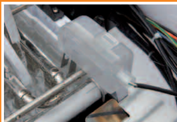
Überschwemmungsschutzvorrichtung Die Platine steuert eine Höchstzeit für die Wasserzufuhr.
